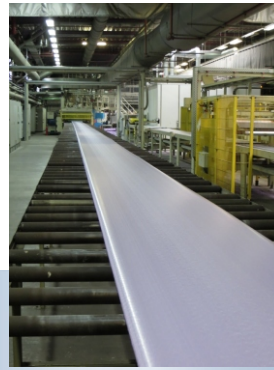
Produkt nach dem Extruder, vor dem Bearbeitungsschritt Planfräsen.
